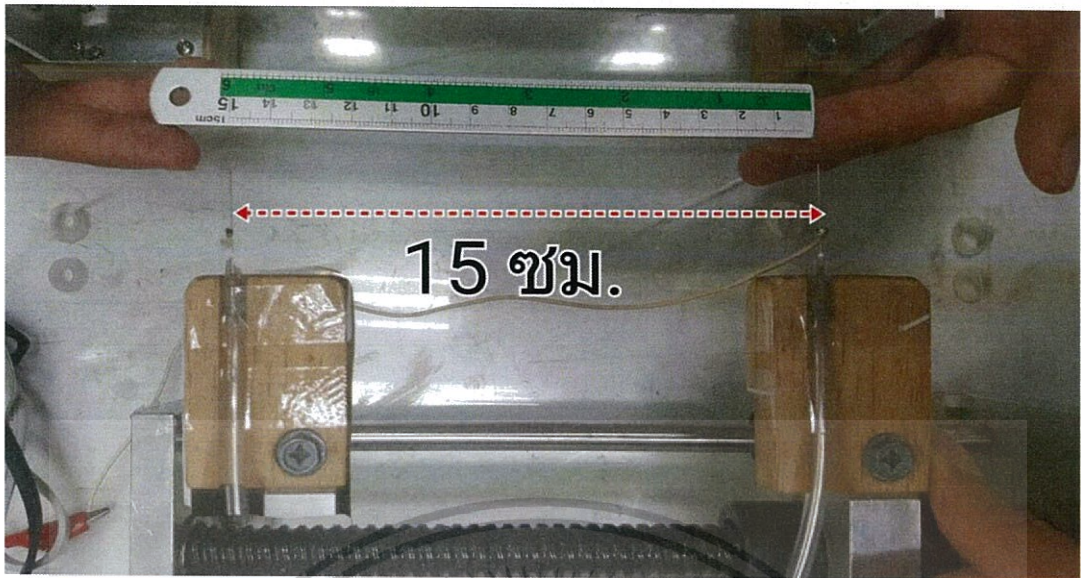
รูปที่ 4.2 ระยะสูงสุดที่ชุดเลื่อนเข็มสามารถเคลื่อนที่ได้
