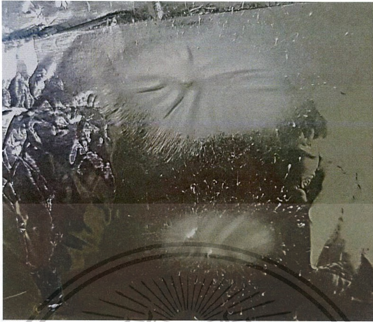
รูปที่ 4.5 เส้นใยที่ได้จากการทำอิเล็กโทรสปินนิ่งแบบทั่วไป
