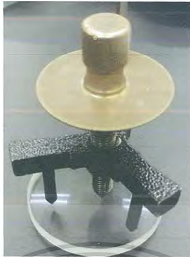
รูปที่ 3.18 แสดงการหาค่าความโค้งของเลนส์ด้วยสเฟียโรมิเตอร์
