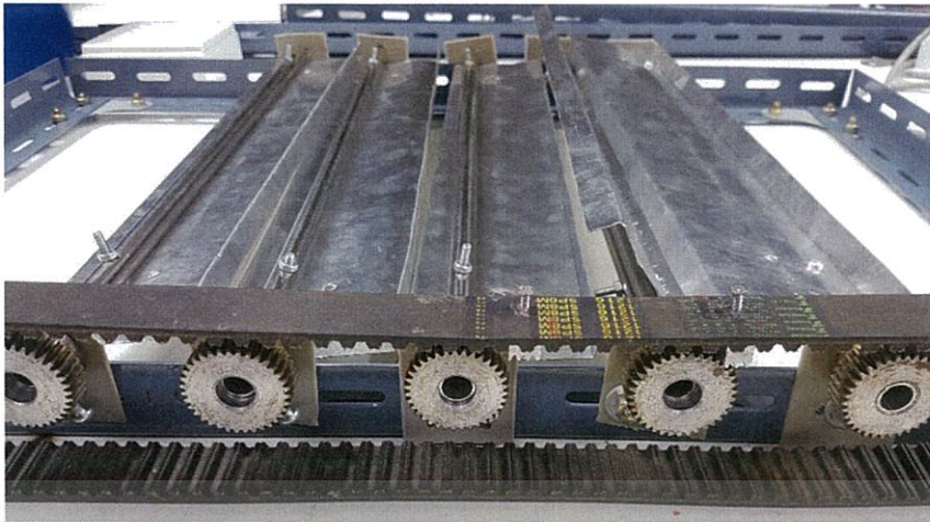
รูปที่ 4.21 ต้นแบบระบบหลังคาอัจฉริยะแบบที่ 3 พลิกแผ่นที่ 3 และเริ่มพลิกแผ่นที่ 4
