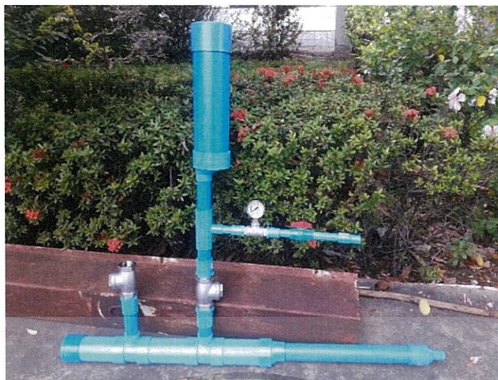
รูปที่ 4.46 แรมปั๊มแบบที่ 1 ที่ประกอบเสร็จ
