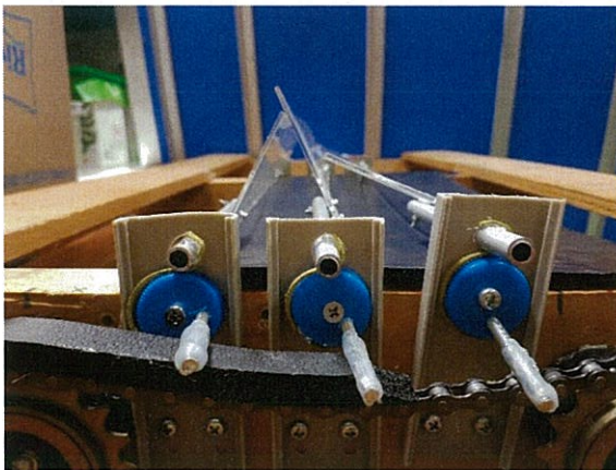
รูปที่ 4.11 ต้นแบบระบบหลังคาอัจฉริยะแบบที่ 2 ขณะแผ่นเกล็ดที่ 2 เริ่มพลิก
