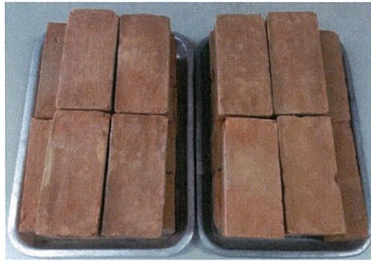
รูปที่ 3.15 อิฐที่เผาเรียบร้อยแล้วทิ้งไว้ให้เย็นแล้วนำมาทดสอบ
