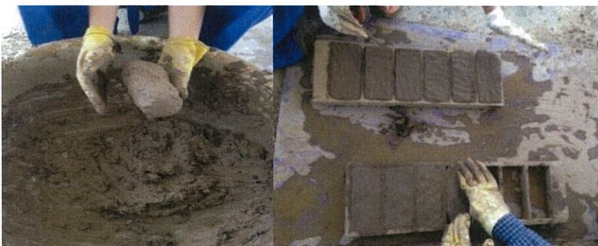
รูปที่ 3.11 ขั้นตอนปั้นอิฐและอัดลงในแบบพิมพ์
