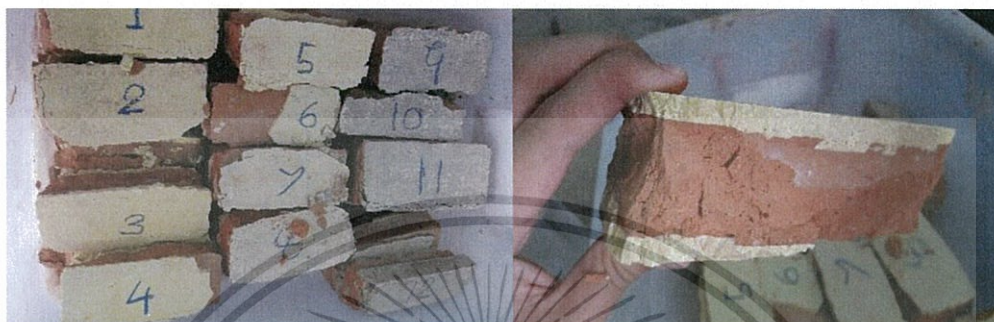
รูปที่ 3.20 อัฐที่ทดสอบแรงอัดจนเกิดการวิบัติ
