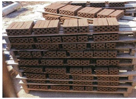
รูปที่ 2.5 นำอิฐที่รีดออกมาเรียงไว้ที่รองอิฐ
