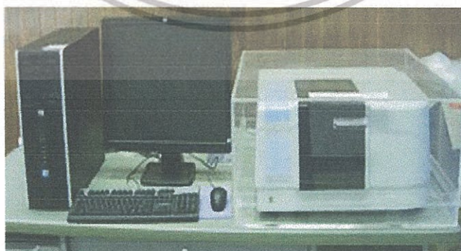
รูปที่ 2.14 เครื่องฟูริเออร์ทรานส์ฟอร์มอินฟราเรดสเปกโตรมิเตอร์ (Fourier Transform Infrared Spectrometer, FT-IR)
