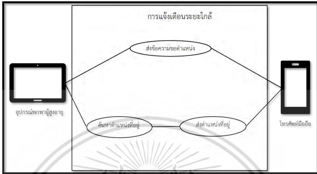
รูปที่ 3.3 Use case diagram ของระบบการแจ้งเตือนระยะไกล
