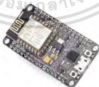
รูปที่ 2.2 NodeMCU บอร์ด ESP8266 (อ้างอิงโดย https://goo.gl/E91hWV )
