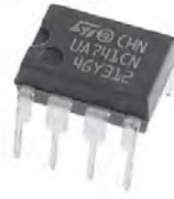
รูปที่ 3. 12 ไอซีขยายสัญญาณเบอร์ UA741CN (Op-Amp)
