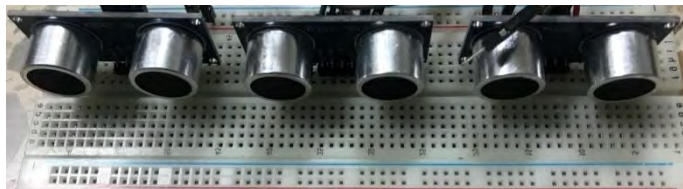
รูปที่ 4.10 เซนเซอร์ตรวจจับวัตถุโดยใช้ Ultrasonic
