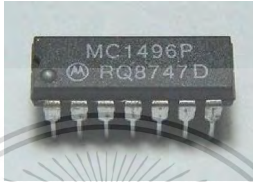
รูปที่ 3.9 ไอซีมอดูเลชัน MC1496
