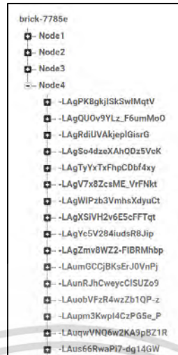
รูปที่ 4.23 การเก็บข้อมูลของ NodeMCU โหนดที่ 4 โดยจะเก็บข้อมูลในแต่ละครั้งเป็น Keys
