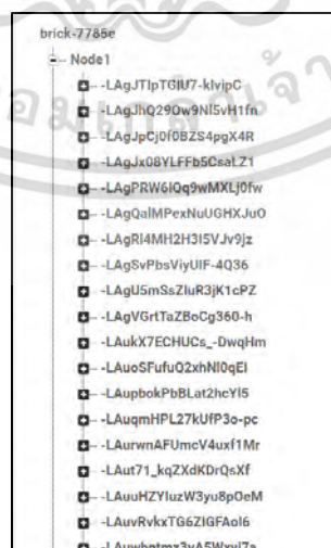
รูปที่ 4.20 การเก็บข้อมูลของ NodeMCU โหนดที่ 1 โดยจะเก็บข้อมูลในแต่ละครั้งเป็น Keys
