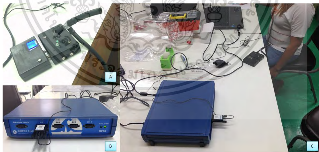
รูปที่ 4.28 ภาพอุปกรณ์ตรวจจับการเคลื่อนไหวของทารก (ภาพ A) กับ BIOPAC (ภาพ B) ขณะทำการวัดสัญญาณการหายใจในคนปกติ (ภาพ C)
