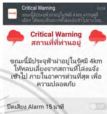
รูปที่ 14 หน้าจอในการแจ้งเตือนเมื่อเกิดฟ้าผ่าขึ้น โดยระบบจะทำการแจ้งเตือนผ่าน Notification ของเครื่องนั้นๆ
