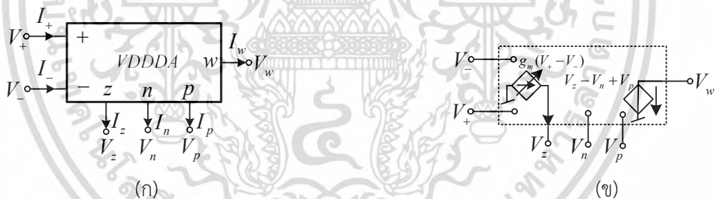
รูปที่ 2.1 (ก) สัญลักษณ์ (ข) วงจรเทียบเคียงของ VDDDA
