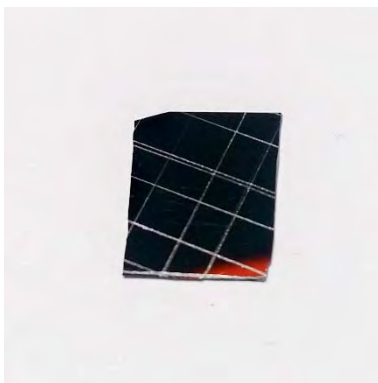
รูปที่ 3.1 ตัวอย่างแผ่นซีลิกอนชนิดกริดเป็นร่องเป็นลักษณะตารางขนาด 1 ตารางเซนติเมตร
