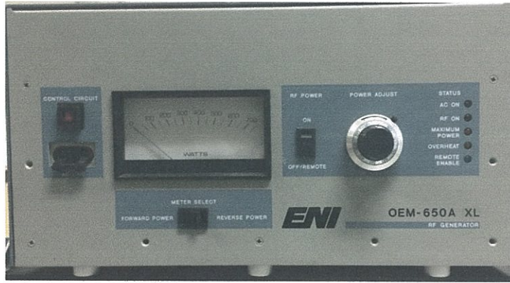
รูปที่ 3.6 เครื่องแหล่งจ่ายกำลังคลื่นความถี่วิทยุของบริษัท ENI รุ่น OEM – 650A XL
