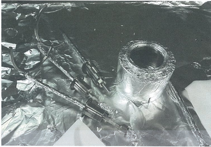
รูปที่ 3.9 อุปกรณ์ที่ท่อฟอยล์อลูมิเนียมและพร้อมติดตั้งในระบบสุญญากาศ
