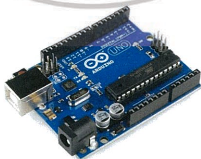
รูปที่ 2.3 บอร์ด Arduino UNO R3 (อ้างอิงโดย https://goo.gl/KeoCEg )
