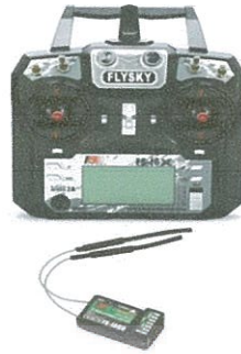
รูปที่ 4.7 ชุดอุปกรณ์ควบคุมมอเตอร์ผ่านสัญญาณวิทยุ
