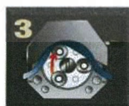
3 อัตราเร็วในการเคลื่อนที่ของสารภายในสาย จะขึ้นอยู่กับขนาดของรูท่อยางในช่องสายยาง และอัตราเร็วการหมุนของลูกรีด
