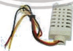
รูปที่ 2.4 เซนเซอร์วัดอุณหภูมิและความชื้น
