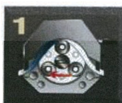
1 Peristaltic pump มีหลักการทำงานโดยใช้แรงกด บีบลงบนสายยางที่อยู่ระหว่างลูกรีด
