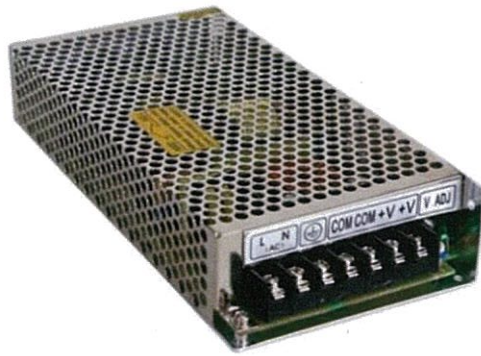
รูปที่ 3.7 สวิตชิงเพาเวอร์ซัพพลาย
