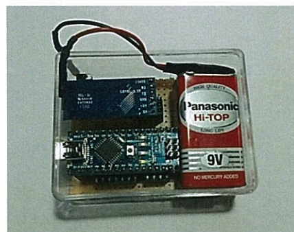
รูปที่ 3.44 วงจรที่ใช้กับเครื่องวัดแรงกดผ่านเครือข่ายไร้สายสำหรับการเดิน
