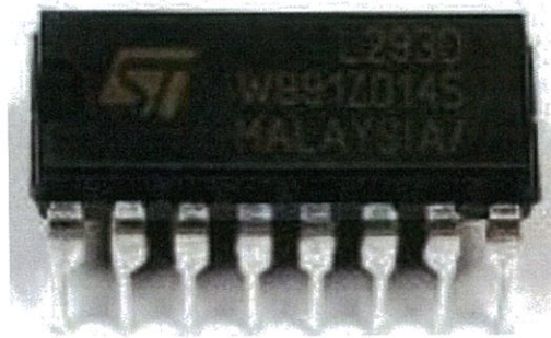
รูปที่ 3.9 DC Motor Driver L293 IC
