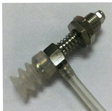
รูปที่ 4.3 การทดสอบการทำงานของยางดูดจับแบบที่ 1
