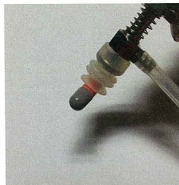
รูปที่ 4.3 การทดสอบการทำงานของยางดูดจับแบบที่ 1
