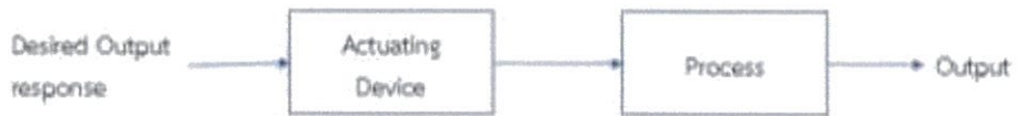
รูปที่ 2.3 แสดง Block Diagram ของการควบคุมแบบวงเปิด
