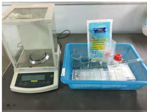
รูปที่ 3.12 อุปกรณ์ที่ใช้ในการเตรียมสารเคลือบ QCM
