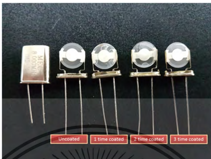
รูปที่ 4.13 รูปแสดงความแตกต่างของQCMที่ไม่ได้เคลือบและเคลือบฟิล์มบางที่มีความหนาต่างๆ
