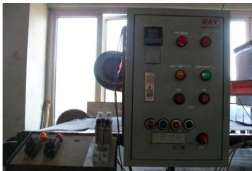
รูปที่ 4.29 ตู้ควบคุมสายพานลำเลียง มอเตอร์ ชุดเป่าลมร้อน และจอแสดงค่าอุณหภูมิภายในตู้อบ
