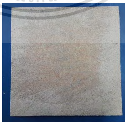
รูปที่ 4.34 แผ่นไม้ปาล์มน้ำมันจากเนื้อไม้ด้านใน แผ่นสี่เหลี่ยม ขนาด 200x 200 หนา 20 มิลลิเมตร
