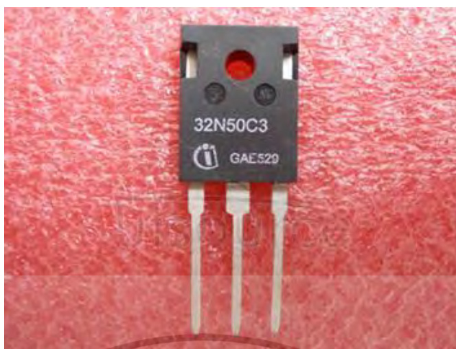
รูปที่ 3.23 มอสเฟตเบอร์ SPW32N50C3
