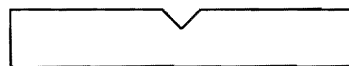
รูปที่ 3.2 แสดงลักษณะชิ้นงานที่ใช้ในการทดสอบสมบัติความทนต่อแรงกระแทก
