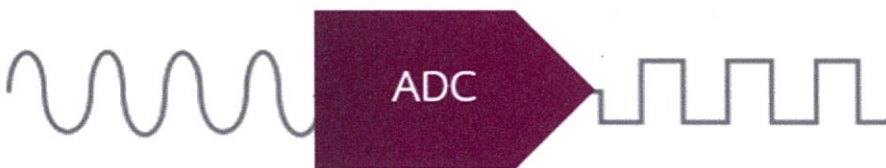
รูปที่ 2.33 ภาพการแปลงข้อมูลแบบ ADC
