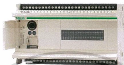
รูปที่ ก.1 ลักษณะของอุปกรณ์ PLC Schneider รหัสรุ่น TWDLCAE40DRF
