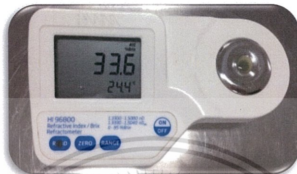
รูปที่ 3.45 เครื่อง refractometer (HI 96800, HANNA, Romania)
