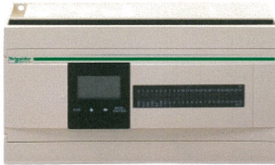
รูปที่ 2.28 Schneider TWDLCAE40DRF compact PLC
