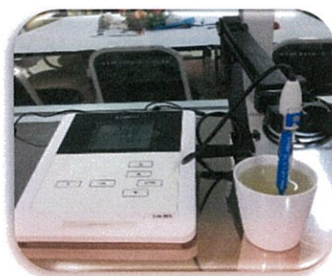
รูปที่ 3.44 pH meter (Lab 855, SI Analytics, Germany)
