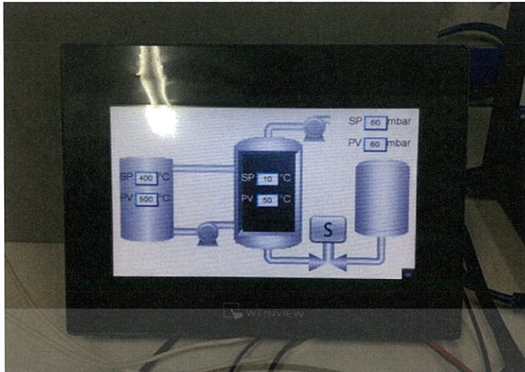
รูปที่ 3.7 อุปกรณ์ที่ใช้ในการควบคุมกระบวนการเชื่อมส่วนของการควบคุมและแสดงผล
