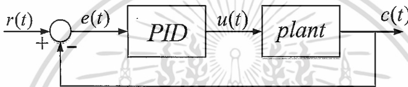
รูปที่ 2.32 ระบบควบคุมแบบป้อนกลับที่ใช้ตัวควบคุมแบบพีไอดี
