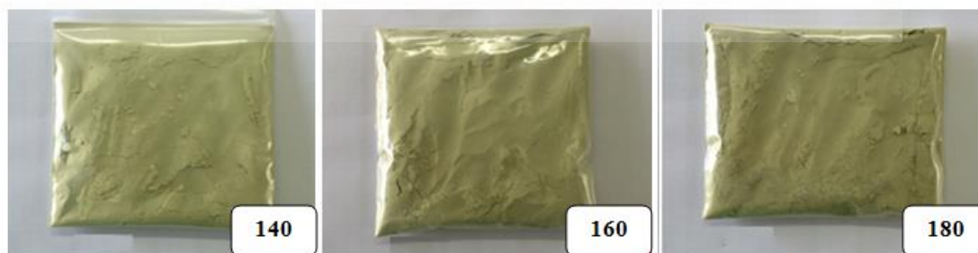
ภาพที่ 4.2 น้ำใบย่านางผงเมื่ออบแห้งแบบพ่นฝอยที่อุณหภูมิความร้อนขาเข้า 140, 160 และ 180 องศา
