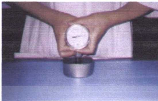
ภาพที่ 10 การวัดค่าความเป็นสุญญากาศของน้ำพริก่องบรรจุกระป๋องด้วย vacuum gauge
