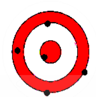
ภาพที่ 2.9 ค่าความแม่นยำและความเที่ยงตรงต่ำ (Low accuracy and Low precision )
