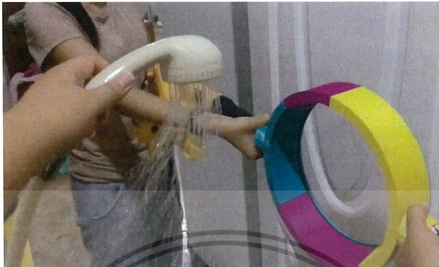
รูปที่ 4.41 การหมุนของน้ำที่มีลักษณะเป็นไซโคลนของต้นแบบพัดลมไร้ใบพัดที่เป็นไซโคลนแบบสั่งพิมพ์ด้วยเครื่องพิมพ์สามมิติเป็นรูปร่างแหวน ที่เส้นผ่านศูนย์กลาง 27 cm โดยใช้ทิศทางของน้ำตั้งฉากกับไซโคลน
