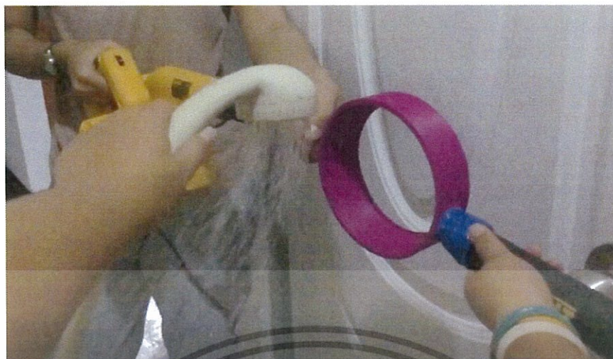
รูปที่ 4.39 การหมุนของน้ำที่มีลักษณะไม่เป็นไซโคลนของต้นแบบพัดลมไร้ใบพัดแบบสั่งพิมพ์ด้วยเครื่องพิมพ์สามมิติเป็นรูปวงแหวน โดยใช้ทิศทางของน้ำตั้งฉากกับไซโคลน
