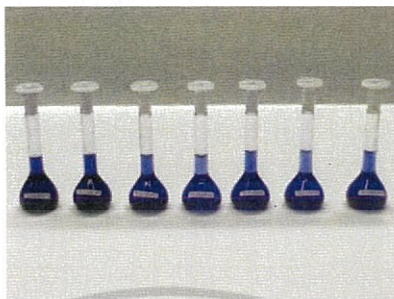
รูปที่ 3.9 สารละลายไทโอนินในฟอสเฟตบัฟเฟอร์พีเอช 4.00 ถึง 10.00
