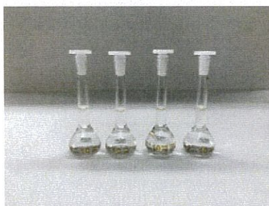
รูปที่ 3.11 สารละลายมาตรฐานกรดแอสคอร์บิก, กรดยูริก, โดปามีน และไทโรซีน ความเข้มข้น 1 มิลลิโมลาร์ในฟอสเฟตบัฟเฟอร์พีเอช 7.00
