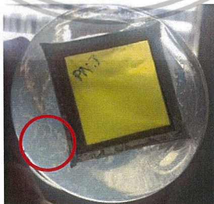
รูปที่ 4.9 ลักษณะการหลุดออกของคาร์ราจีแนนจากฟิล์มชั้นในของฟิล์มสูตร CS-C-T-3 และ CS-C-T-5
