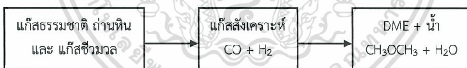
รูปที่ 2.3 กระบวนการผลิตไดเมทิลอีเทอร์แบบทางตรง (Direct DME Synthesis) [6]
