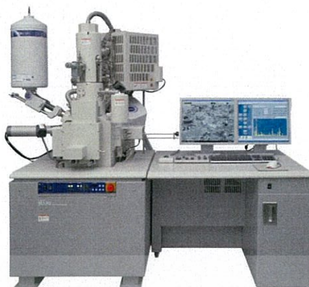
รูปที่ 3.3 กล้องจุลทรรศน์อิเล็กตรอนแบบส่องกราด (SEM)
