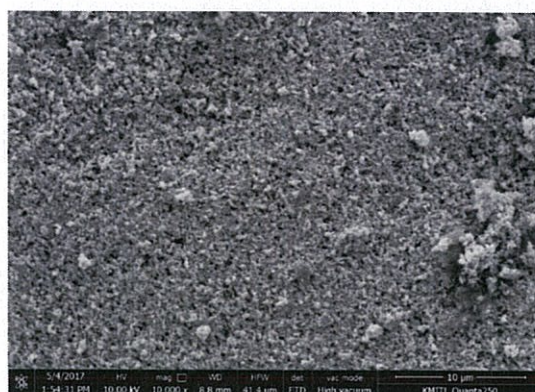
ฉ) 30wt% \text{WO}_3/\text{SnO}_2 ที่ผ่านการใช้งานแล้ว (กำลังขยาย 10,000 เท่า)
