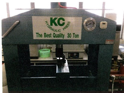
รูปที่ 3.4 แสดงการอัดเม็ดมวลวรามิกด้วยเครื่องอัดแบบไฮดรอลิก
