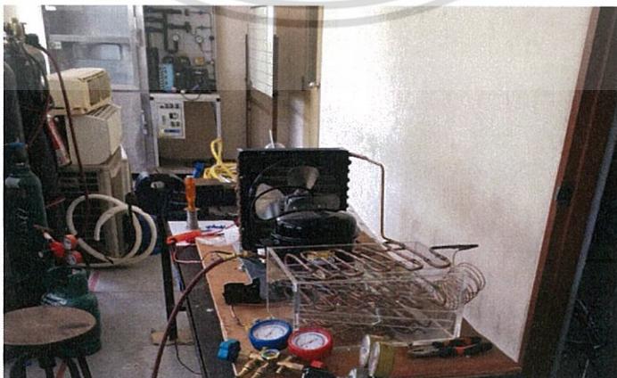
รูปที่ 3.52 นำกล่องมาประกอบเข้ากับเครื่องทั้งหมด
