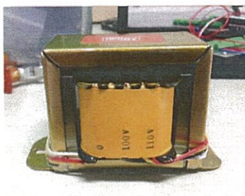
รูปที่ 3.3 แหล่งจ่ายไฟให้กับ Motor Driver
