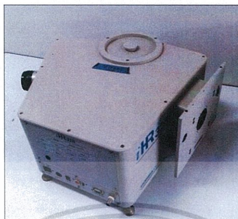
รูปที่ 2.9 แสดงภาพเครื่องแยกความยาวคลื่น ( Monochromator )
