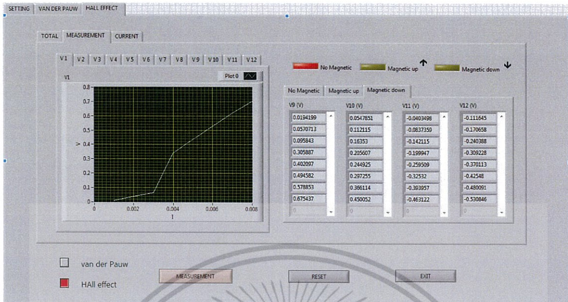
รูปที่ 4.7 โปรแกรมสามารถทำการวัดปรากฏการณ์ฮอลล์ได้โดยการกดเลือกรูปแบบของการวัดเป็นปรากฏการณ์ฮอลล์, กดปุ่ม Measurement และกด Ctrl R เพื่อ Run Program
