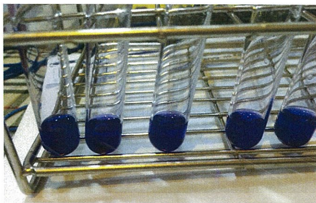
รูปที่ 4.5 แสดงสีของสารละลาย n -Butanol ของตัวอย่างปากกา A1-A2-A3-A8-A12
