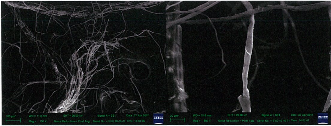
รูปที่ 4.62 สัณฐานวิทยาของเส้นใยจากใบสับปะรด (กำลังขยาย 100 และ 500 เท่า ตามลำดับ)
