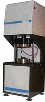
รูปที่ 2.9 เครื่องวัดความหนืดของยาง [21]
