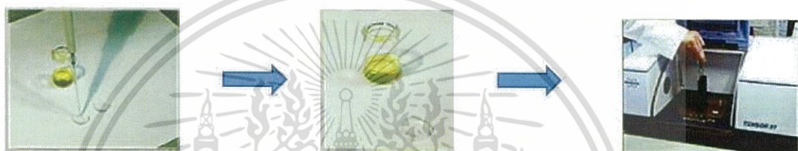
รูปที่ 2.16 การเตรียมตัวอย่างที่เป็นของเหลวโดยหยดบน KBr cell (ศูนย์เครื่องมือวิทยาศาสตร์ มหาวิทยาลัยสงขลานครินทร์, 2556)
