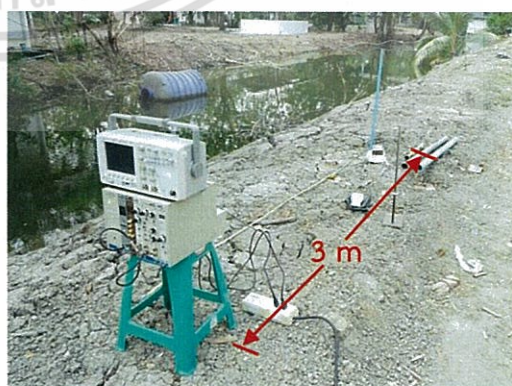
รูปที่ 4.6 การจัดวางอุปกรณ์วัดความชื้น ของดินด้วยรังสีนิวตรอน
