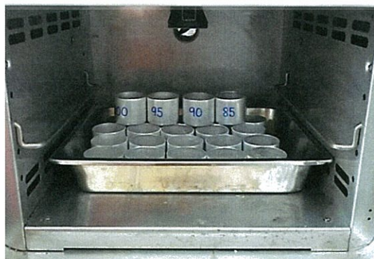
รูปที่ 4.12 อบตัวอย่างดินด้วยตู้อบความชื้น
