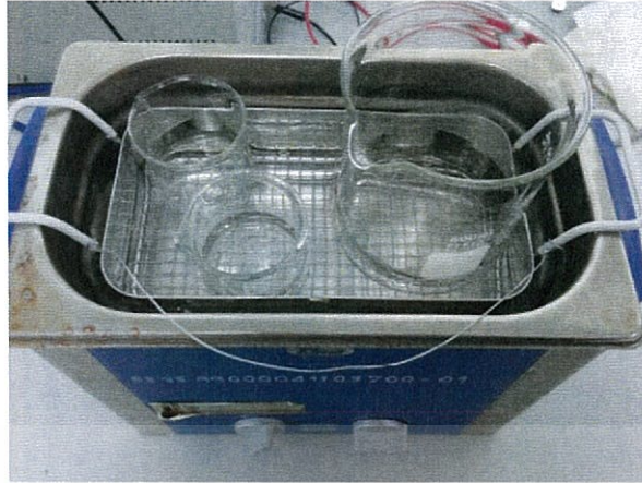
รูปที่ 3.22 ชิ้นงานระหว่างการทำความสะอาดด้วยอัลตราโซนิก
