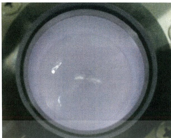
รูปที่ 3.24 ชั้นงานระหว่างการทำความสะอาดด้วยพลาสมาโดยใช้แก๊สอาร์กอน
