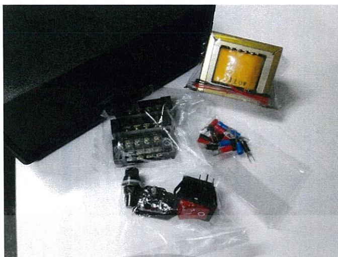
รูปที่ 3.16 อุปกรณ์กล่องควบคุมอัตราการไหลของแก๊ส
