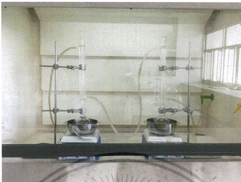
รูปที่ 3.5 แสดงการตั้งอุปกรณ์รีฟลักซ์สำหรับปฏิกิริยาทรานส์เอสเทอร์ฟิเคชัน
