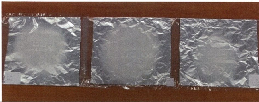
a แผ่นเส้นใยโพลิอิมัลชันที่มีความเข้มข้นไททาเนียมไดออกไซด์ที่ 1, 1.5 และ 2% w/w ตามลำดับ
