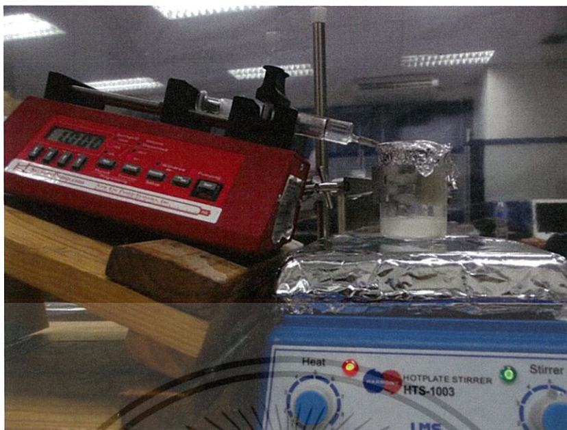
รูปที่ 3.2 การติดตั้งอุปกรณ์การหยดสารละลายพอลิแลคติกแอซิดลงไปในการละลายพอลิไวนิลแอลกอฮอล์เพื่อให้เกิดเป็นอิมัลชัน
