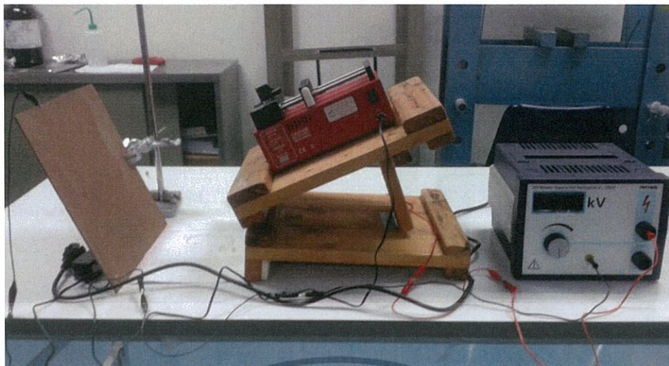
รูปที่ 3.3 การติดตั้งอุปกรณ์การป้อนเส้นใยด้วยไฟฟ้าสถิต
