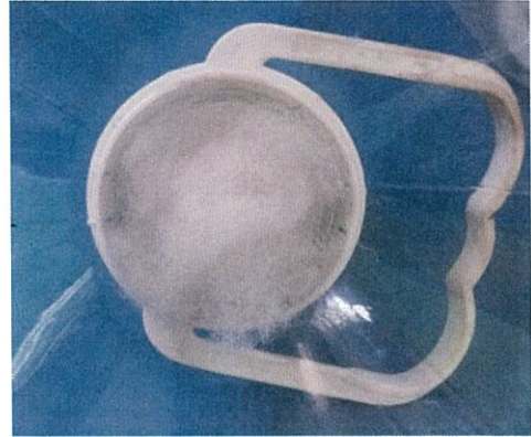
รูปที่ 3.8 วิธีบรรจุใยสังเคราะห์บริเวณด้านในฝาถัง
