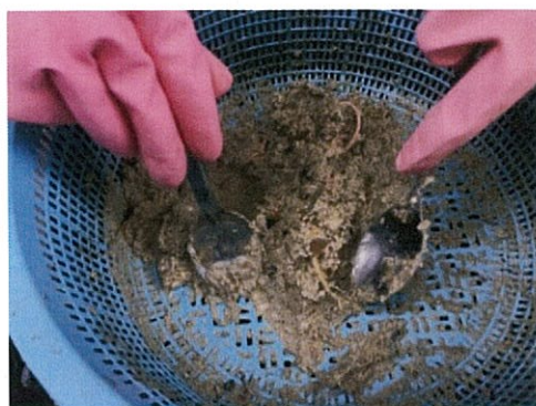
รูปที่ 3.4 วิธีบดตัวอย่างกากไขมันผ่านตะแกรง
