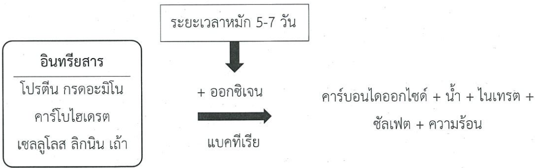
รูปที่ 2.1 กระบวนการหมักแบบใช้ออกซิเจน (Aerobic Decomposition)
