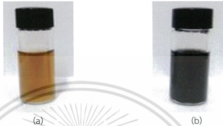
รูปที่ 4.3 แสดงสีของสารแขวนลอยกราฟีนออกไซด์ (a) และสารแขวนลอยรีดิวซ์กราฟีนออกไซด์ (b)
