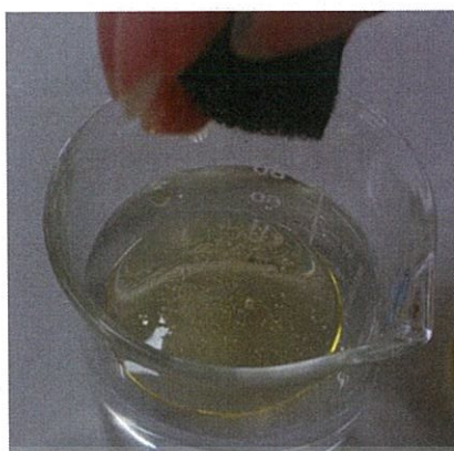
รูปที่ 4.28 แสดงภาพการบีบน้ำมันที่เกิดจากการดูดซับของพอลิยูรีเทนโฟมที่เคลือบด้วยรีติวซ์-กราฟีนออกไซด์ปริมาณ 20 มิลลิกรัม
