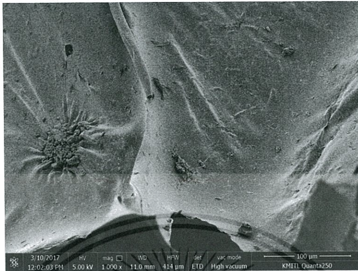
รูปที่ ก-17 แสดงลักษณะทางสัณฐานวิทยาที่กำลังขยาย 1000X เท่าของรีดิวซ์กราฟีน-ออกไซด์เคลือบบนพอลิเอทรีเทนโพลีเมอร์ 30 มิลลิกรัม
