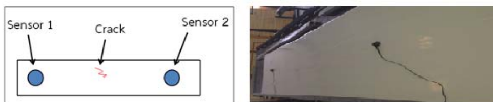
รูปที่ 3.6 การวางตำแหน่ง PZT Sensor สำหรับตรวจสอบรอยร้าวในรูปแบบ 1 มิติ
