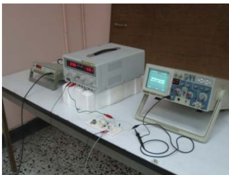
รูปที่ 3.2 การตรวจรับสัญญาณเสียงผ่านวงจรขยายสัญญาณมาเป็นสัญญาณไฟฟ้า
