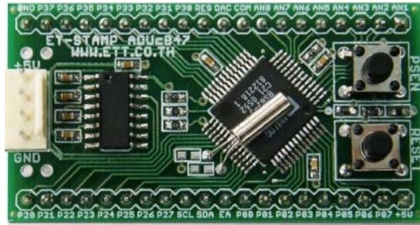
รูปที่ 2.16 บอร์ด ET-STAMP ADuC847 เป็นบอร์ดไมโครคอนโทรลเลอร์ในตระกูล MCS51
